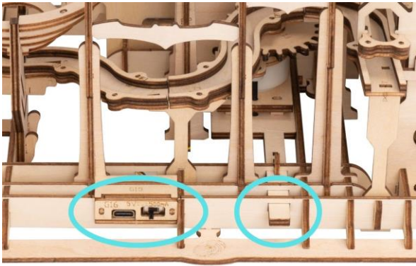
左：USB 差し込み口と電源スイッチ 右：手動式/電動式切り替えスイッチ
